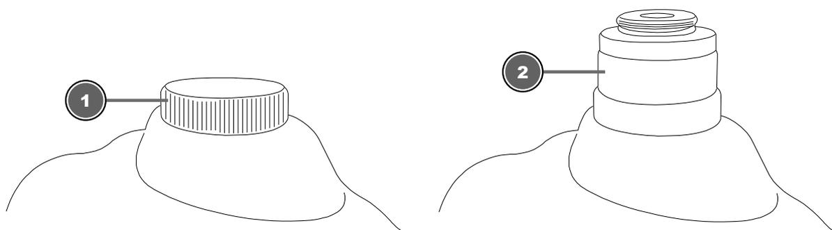
Abb. 4: Trinoaufsatz und aufgeschraubter Fotoadapter
